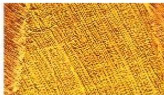
In questa micrografia al microscopio elettronico a scansione sono visibili gli strati di fibrille di cellulosa responsabili della grande resistenza meccanica delle pareti delle cellule vegetali.
